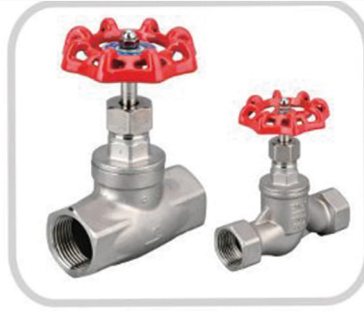
品名 (NAME) : 螺纹截止阀 THREAD GLOBE VALVE 尺寸 (SIZE) : 1/2"-4" 材质 (MATERIAL) : CF8/CF8M 压力 (PRESSURE) : 200WOG 标准 (STANDARD) : BSPT/BSPP/NPT DIN259/DIN2999 DIN EN ISO228
