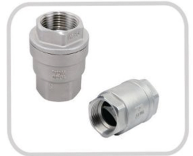
品名 (NAME) : 立式止回阀 VERTICAL CHECK VALVE 尺寸 (SIZE) : 1/4"-4" 材质 (MATERIAL) : CF8/CF8M 压力 (PRESSURE) : 1000WOG 标准 (STANDARD) : BSPT/BSPP/NPT DIN259/DIN2999 DIN EN ISO228
