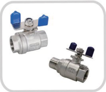
品名 (NAME) : 蝶形手柄球阀 BUTTERFLY HANDLE BALL VALVE 尺寸 (SIZE) : 1/4"-2" 材质 (MATERIAL) : CF8/CF3/CF8M/CF3M WCB/2205/2507 压力 (PRESSURE) : 1000WOG/PN64 标准 (STANDARD) : BSPT/BSPP/NPT DIN259/DIN2999 DIN EN ISO228
