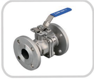
品名 (NAME) : 化工部高平台法兰球阀 HG FLANGE BALL VALVE ISO5211 尺寸 (SIZE) : 1/2"-12" 材质 (MATERIAL) : CF8/CF8M/WCB 标准 (STANDARD) : 国标 (HG/20592)
