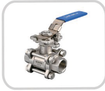
品名 (NAME) : 三片式高平台球阀 3PC BALL VALVE WITH ISO5211 PAD 尺寸 (SIZE) : 1/4"-4" 材质 (MATERIAL) : CF8/CF3/CF8M/CF3M WCB/2205/2507 压力 (PRESSURE) : 1000WOG/PN64 标准 (STANDARD) : BSPT/BSPP/NPT DIN259/DIN2999 DIN EN ISO228
