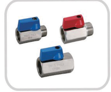
品名 (NAME) : 迷你球阀(内螺纹, 内外螺纹, 外螺纹) MINI BALL VALVE (CONNECTION END M/M, F/M, F/F) 尺寸 (SIZE) : 1/8"-1" 材质 (MATERIAL) : CF8/CF8M 压力 (PRESSURE) : PN63/1000WOG 标准 (STANDARD) : BSPT/BSPP/NPT DIN259/DIN2999 DIN EN ISO228
