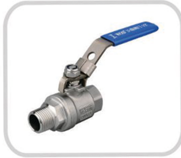
品名 (NAME) : 二片式内外螺纹球阀 2PC BALL VALVE F/M 尺寸 (SIZE) : 1/4"-4" 材质 (MATERIAL) : CF8/CF3/CF8M/CF3M WCB/2205/2507 压力 (PRESSURE) : 1000WOG/PN64 标准 (STANDARD) : BSPT/BSPP/NPT DIN259/DIN2999 DIN EN ISO228
