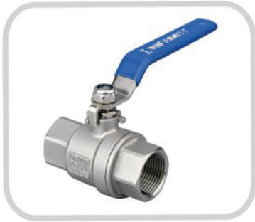
品名 (NAME) : 二片式德标球阀 2PC BALL VALVE DIN 3202 尺寸 (SIZE) : 1/4"-4" 材质 (MATERIAL) : CF8/CF3/CF8M/CF3M WCB/2205/2507 压力 (PRESSURE) : PN63 标准 (STANDARD) : BSPP/DIN259/DIN2999 DIN EN ISO228
