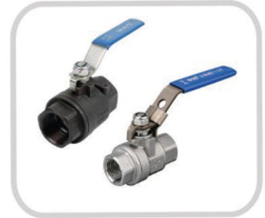
品名 (NAME) : 二片式重型球阀 2PC HEAVY TYPE BALL VALVE 尺寸 (SIZE) : 1/4"-4" 材质 (MATERIAL) : CF8/CF3/CF8M/CF3M WCB/2205/2507 压力 (PRESSURE) : 1000WOG/2000WOG 标准 (STANDARD) : BSPT/BSPP/NPT DIN259/DIN2999 DIN EN ISO228
