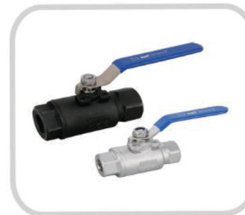
品名 (NAME) : 二片式高压球阀 2PC HIGH PRESSURE BALL VALVE 尺寸 (SIZE) : 1/4"-2" 材质 (MATERIAL) : CF8/CF3/CF8M/CF3M WCB/2205/2507 压力 (PRESSURE) : 1000WOG/PN64 标准 (STANDARD) : BSPT/BSPP/NPT DIN259/DIN2999 DIN EN ISO228
