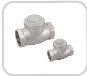
品名 (NAME) : 旋启式止回阀 SWING CHECK VALVE 尺寸 (SIZE) : 1/2"-4" 材质 (MATERIAL) : CF8/CF8M 标准 (STANDARD) : BSPT/BSPP/NPT DIN259/DIN2999 DIN EN ISO228
