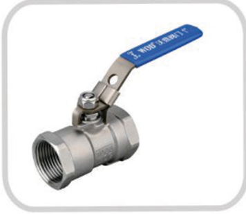
品名 (NAME) : 一片式球阀 1PC BALL VALVE 尺寸 (SIZE) : 1/4"-4" 材质 (MATERIAL) : CF8/CF3/CF8M/CF3M WCB/2205/2507 压力 (PRESSURE) : 1000WOG/PN64 标准 (STANDARD) : BSPT/BSPP/NPT DIN259/DIN2999 DIN EN ISO228
