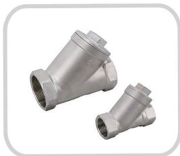
品名 (NAME) : Y型止回阀 Y TYPE CHECK VALVE 尺寸 (SIZE) : 1/4"-4" 材质 (MATERIAL) : CF8/CF8M 压力 (PRESSURE) : 800WOG 标准 (STANDARD) : BSPT/BSPP/NPT DIN259/DIN2999 DIN EN ISO228
