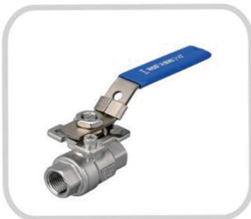
品名 (NAME) : 二片式高平台球阀 2PC BALL VALVE WITH ISO2511 PAD 尺寸 (SIZE) : 1/4"-4" 材质 (MATERIAL) : CF8/CF3/CF8M/CF3M WCB/2205/2507 压力 (PRESSURE) : 1000WOG/PN64 标准 (STANDARD) : BSPT/BSPP/NPT DIN259/DIN2999 DIN EN ISO228
