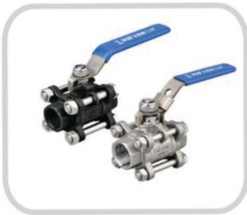
品名 (NAME) : 三片式球阀 3PC BALL VALVE 尺寸 (SIZE) : 1/4"-4" 材质 (MATERIAL) : CF8/CF3/CF8M/CF3M WCB/2205/2507 压力 (PRESSURE) : 1000WOG/PN64 标准 (STANDARD) : BSPT/BSPP/NPT DIN259/DIN2999 DIN EN ISO228
