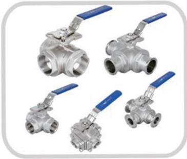
品名 (NAME) : 三通/四通球阀 3-WAY/4-WAY BALL VALVE 尺寸 (SIZE) : 1/4"-4" 材质 (MATERIAL) : CF8/CF8M/WCB 压力 (PRESSURE) : 1000WOG 标准 (STANDARD) : BSPT/BSPP/NPT DIN259/DIN2999 DIN EN ISO228
