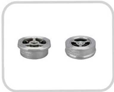
品名 (NAME) : H71对夹式止回阀 H71 WAFER CHECK VALVE 尺寸 (SIZE) : 1/2"-20" 材质 (MATERIAL) : CF8/CF8M/WCB 压力 (PRESSURE) : PN25/PN40 150LB/300LB
