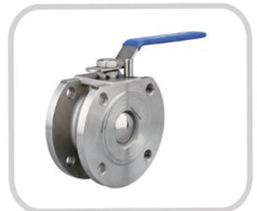
品名 (NAME) : 手动薄型法兰球阀 MANUAL THIN FLANGE BALL VALVE 尺寸 (SIZE) : DN15-DN100 材质 (MATERIAL) : CF8/CF8M/WCB 压力 (PRESSURE) : PN16/PN40
